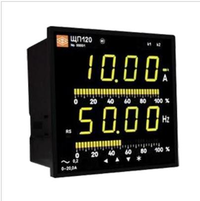
Амперметры и вольтметры переменного тока ЩП120, ЩП96, ЩП72, ЩП02 предназначены для измерения и преобразования действующего значения силы тока, напряжения и частоты в однофазных электрических сетях и других цепях переменного тока в выходные унифицированные сигналы постоянного тока и передачи измеренных значений через последовательный цифровой интерфейс RS485. Приборы могут применяться в трехфазных электрических сетях для измерения и преобразования параметров одной фазы.
