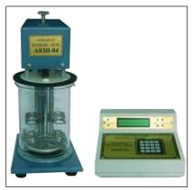
Аппарат автоматический **АКШ-04** предназначен для определения температуры, при которой битум, находящийся в кольце заданных размеров, в условиях испытания размягчается и, перемещаясь под действием стального шарика, касается нижней пластинки.
