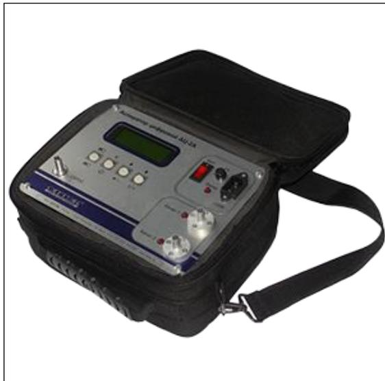
Автоматический аспиратор АЦ-2А предназначен для отбора проб воздуха и (или) газа с заданным объемом при выполнении газоаналитических измерений. Аспиратор позволяет отбирать пробу заданного объема прямым измерением, с установкой расхода со стабилизацией при контроле атмосферного воздуха и воздуха рабочей зоны.
