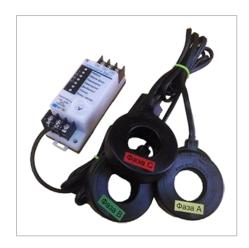
Смартреле-МД-2 предназначено для установки в цепях питания трехфазных электродвигателей и других электроустановок переменного тока промышленной частоты 50 Гц напряжением 230/400 или 400/690 В для их защиты от аварийных режимов работы. При косвенном подключении через трансформаторы тока реле могут использоваться в электролиниях на любое напряжение.
