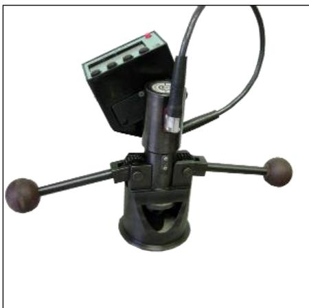
ПОС-50МГ-2ПБ предназначен для неразрушающего контроля прочности ячеистого бетона методом вырыва спирального анкера.
