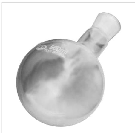
Лабораторные колбы К-1 предназначены для выпаривания, перегонки, разгонки, дистилляции и синтеза в лабораторных условиях.
