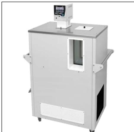
Жидкостные криостаты КРИО-ВИС-Т-05 и КРИО-ВИС-Т-05-01 с двухкамерным стеклопакетом, исключающим запотевание и обмерзание, предназначены для поддержания заданной температуры при проведении измерений вязкости нефтепродуктов при помощи стеклянных вискозиметров в соответствии с ГОСТ 33, ГОСТ Р 53708, ASTM D445, IP 71, ISO 3104 и DIN 51366.
