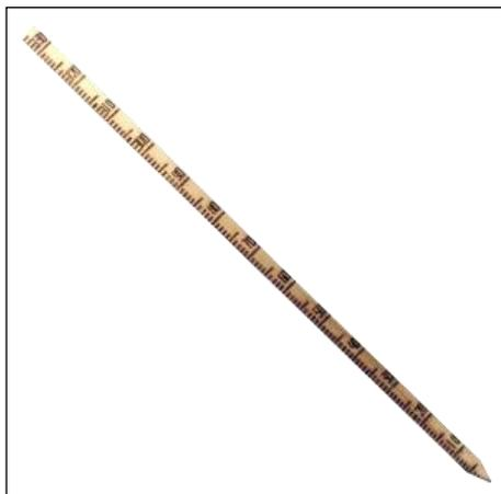
Рейка снегомерная переносная М-104-М предназначена для измерений высоты снежного покрова.
