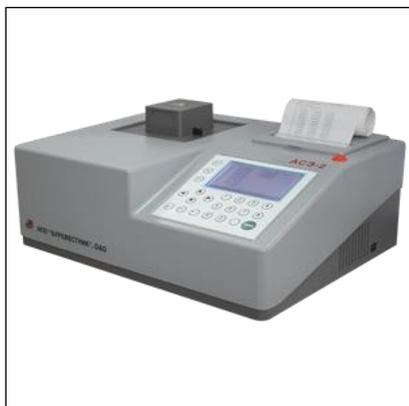
Анализатор серы энергодисперсионный АСЭ-2 предназначен для измерения массовой доли серы в неэтилированном бензине, дизельном топливе, сырой нефти, керосине, нефтяных остатках, основах смазочных масел, гидравлических маслах, реактивных топливах и других дистиллятных нефтепродуктах.
