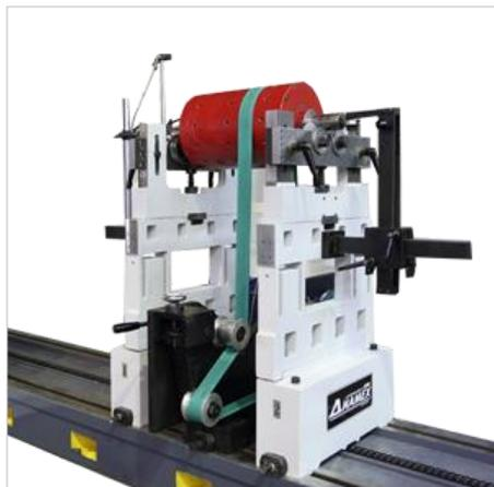
Дорезонансные балансировочные станки с жесткими опорами ВТ-50, ВТ-150, ВТ-300, ВТ-500, ВТ-1000, ВТ-3000, ВТ-6000, ВТ-9000 предназначены для высокоточной балансировки роторов.
