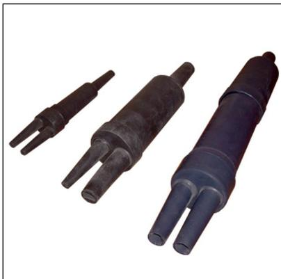
Муфты полиэтиленовые **МП** предназначены для восстановления полиэтиленовой оболочки при монтаже телефонных кабелей типа ТП всех марок. Муфты могут использоваться как на открытом воздухе или в грунте, так и в помещении при температуре окружающей среды от - 50 °С до +60 °С.
