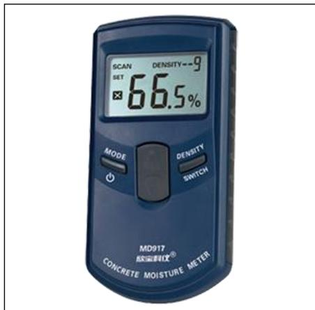
Представляет из себя портативное устройство для измерения влажности бетонных конструкций неразрушающим методом.
