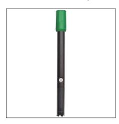
HI-764080 это цифровой датчик растворенного кислорода со встроенным датчиком температуры. Это ультра тонкий полярографический электрод с ячейкой кларка, разработанный для измерения растворенного кислорода в водных растворах.
