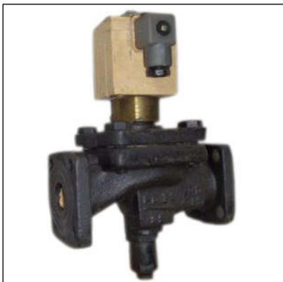
Клапан мембранный с электромагнитным приводом «15кч883р» предназначен в качестве запорного устройства на трубопроводах для автоматического и дистанционного управления потоками природного горючего и нейтральных газов, воздуха и схемах управления газогорелочного оборудования.
