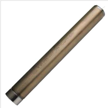
Термоустойчивые коронные счетчики медленных нейтронов СНМ67Э, СНМ56М предназначены для высокоэффективной регистрации нейтронного излучения в физических и радиометрических устройствах, геофизической аппаратуре нейтронного каротажа (для исследования глубоких нефтегазовых скважин с температурой до +150°С) и других отраслях техники при нейтронных измерениях.
