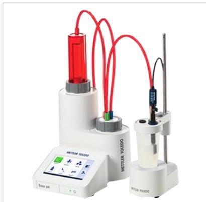
Автоматические титраторы EasyPlus — это простое и доступное решение для стандартного титрования. Титратор специально разработан для выполнения повседневных задач и очень прост в управлении благодаря пользовательскому интерфейсу с клавишами быстрого запуска операций. Простая и понятная навигация на русском языке, а также поддержка 14 иностранных языков. Выполнить настройку и установку, а также подготовить титратор к работе в кратчайшее время вам поможет встроенное руководство EasySetup.
