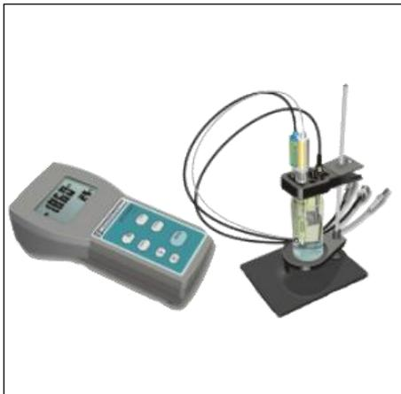
Иономер «Нитратанализатор» предназначен для измерения показателя активности рХ, массовой доли сХ нитрат - ионов NO<sub>3</sub> в соответствии с аттестованными методиками выполнения измерений, а также температуры водных растворов. Измерения рХ (сХ) и температуры осуществляются с помощью измерительного преобразователя (далее - преобразователь) и набора электродов.
