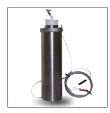
Пробоотборник переносной **ППН** предназначен для отбора проб светлых и темных нефтепродуктов и специальных жидкостей из автомобильных и железнодорожных цистерн, стационарных резервуаров с любого уровня. Разработан и изготовлен в соответствии с требованиями ГОСТ 2517-85 (ASTM D 4057-95) "Нефть и нефтепродукты. Методы отбора проб". Объем отбираемой пробы от 150 до 1000 мл.
