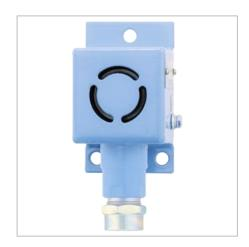
Взрывозащищенный звуковой сигнализатор BC-6M-H предназначен для подачи звуковых сигналов в аварийных ситуациях на объектах с ограниченной мощностью питающего напряжения (потребляемая мощность не более 400 мВт).
