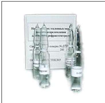
Набор жидких эталонных мер показателя преломления РЖЭ-1 предназначен для использования в качестве рабочего эталона показателя преломления на длине волны желтой спектральной линии натрия D (589.3 нм) при поверке, калибровке и ремонте автоматических цифровых рефрактометров в ранге рабочих средств измерений в соответствии с МИ 2129-91 «ГСИ. Государственная поверочная схема для средств измерений показателя преломления твердых и жидких прозрачных веществ».
