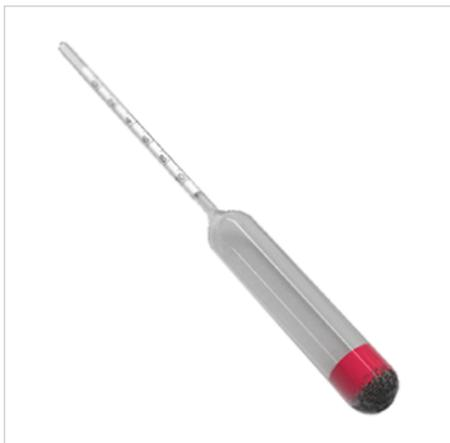
Ареометр АС–2, ареометр АС–3, ареометр АСТ–1 и ареометр АСТ–2 используются в лабораториях предприятий химической, пищевой, сельскохозяйственной и других сфер промышленности для качественного определения массовой доли сахара в различных водных растворах.
