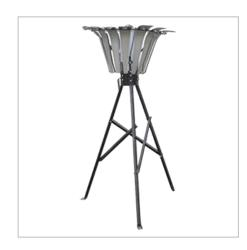
Осадкомер Третьякова О-1М предназначен для сбора в любое время года и последующего измерения количества выпавших осадков на гидрометеорологических станциях. Изготавливается для нужд народного хозяйства и эксплуатируются при температуре от минус 50 до плюс 50 С.
