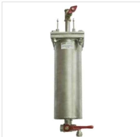
Теплообменники ТО-290, ТО-145 применяются в технологических процессах атомных, тепловых и электрических станций, котельных и других объектов для охлаждения пробы, подаваемой на приборы автоматического и ручного химического контроля.
