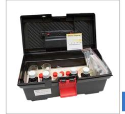
Тест-комплект «Кислород КВ» предназначен для экспрессопределения кислорода в пресных технических водах исходной, сетевой, подпиточной, питательной, составляющих ее конденсатах, в котловых, циркулирующих в системах охлаждения и теплофикационных водах (РД 24.031.120-91, РД 24.032.01-91). Метод определения: визуальноколориметрический.
