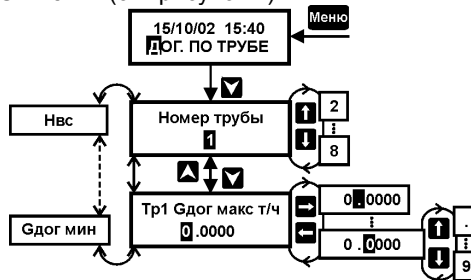
Рисунок 7 – Установка договорных параметров по трубопроводам
