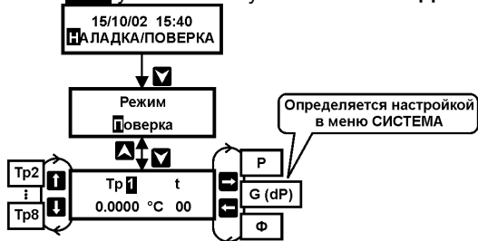
Рисунок 15 – Последовательность действий при выполнении поверки
