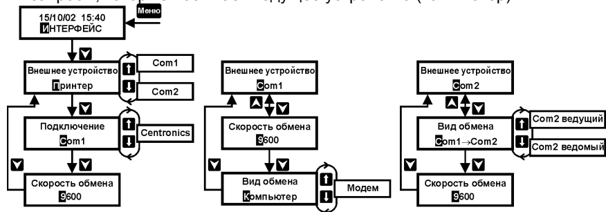
Рисунок 10 – Установка параметров интерфейса
