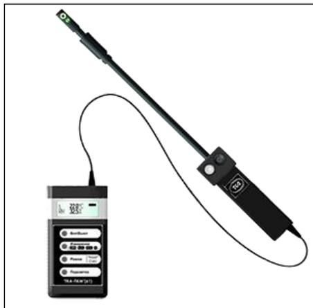
Предназначен для измерения, как фотометрических параметров, так и основных параметров микроклимата: яркости протяжённых самосветящихся объектов накладным методом (экранов мониторов), освещённости в видимой области спектра (380 ÷ 760) нм, скорости движения, температуры и относительной влажности воздуха внутри помещений.
