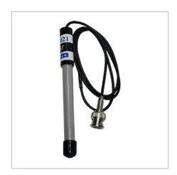
Электрод ионоселективный Элит-021 является первичным измерительным преобразователем активности ионов NO3-(нитрат - ионов) в электродвижущую силу.
