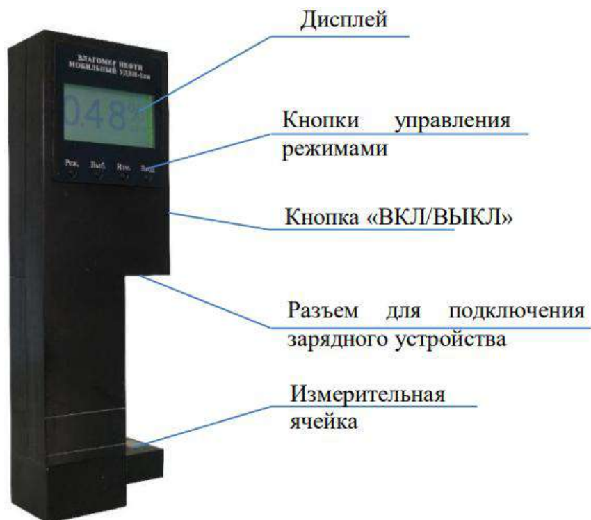
Внешний вид мобильного влагомера нефти УДВН-1лм
