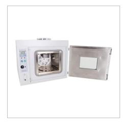
Печь для старения битума в тонкой плёнке (метод RTFOT). Предназначена для определения степени сопротивления битума старению под воздействием высокой температуры и воздуха.
