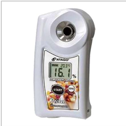
Цифровой рефрактометр PAL-Dried Fruit Moisture предназначен для быстрого определения влажности в сухофруктах.
