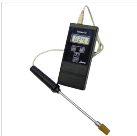
Гигрометр Замер-22 предназначен для измерения температуры и относительной влажности воздуха в различных технологических процессах.
