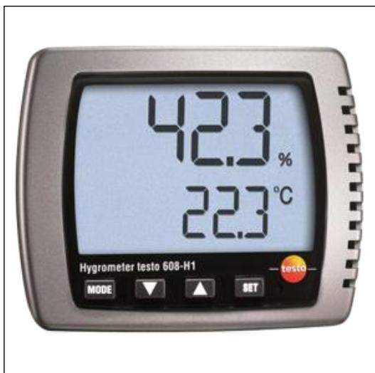
**Testo 608-H1** – термогигрометр. Предназначен для непрерывного измерения влажности, температуры и температуры точки росы. Большой дисплей позволяет считывать данные измерений даже на расстоянии. Корпус гигрометра предусматривает возможность закрепления на стене или столе. Высокая стабильность сенсоров обеспечивает долгосрочную надежность результатов измерений.
