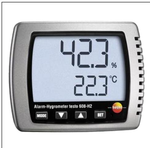
**Testo 608-H2** - термогигрометр. Прибор с функцией LED-сигнализации, своевременно оповестит Вас о превышении предельно допустимых значений влажности и температуры, например, в садоводческих магазинах, складских помещениях, чистых комнатах, музеях, лабораториях и т.п.
