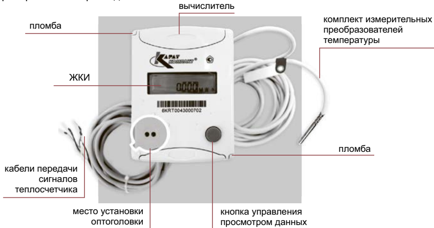
Рисунок 4 — Измерительная часть теплосчетчика
