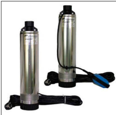
Погружные скважинные центробежные электронасосы серии «ВОДОМЕТ» предназначаются для перекачивания воды из различных источников, включая открытые водоемы, резервуары (с внутренним диаметром не менее 100 мм.), колодцы с целью подачи воды в дом, огород, сад. Насосы данной серии являются многоступенчатыми с «омываемым» электродвигателем, «плавающими» рабочими колесами и встроенным конденсатором.
