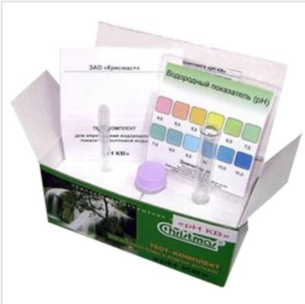
Тест-комплект рН-КВ предназначен для аналитического определения рН (отрицательного десятичного логарифма концентрации водородных ионов) в пресных технических водах – исходной, сетевой, подпиточной, питательной, составляющих ее конденсатах, в котловых, циркулирующих в системах охлаждения и теплофикационных водах (РД 24.031.120-91, РД 24.032.01-91).
