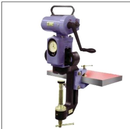
Прибор предназначен для измерения твердости металлов по методу Бринелля.
