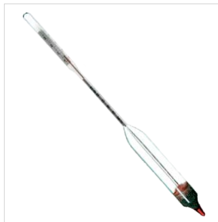
АМТ (1015-1040) ареометр для молока с термометром
