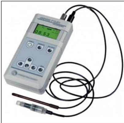
Прибор «АНИОН 7040» представляет собой лабораторный кислородомер/БПК-тестер  $\text{CO}_2 + \text{БПК} + ^\circ\text{C}$ .
