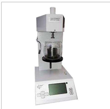
ПНУ-05 предназначен для определения пенетрации нефтяных битумов и пластичных смазок путем автоматического измерения глубины погружения в испытуемый образец стандартной по массе, форме и размерам иглы (ГОСТ 33136-2014, ГОСТ 11501) или конуса (ГОСТ 5346) при заданной температуре в течение заданного времени.
