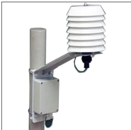
Прибор ИПСЭС-1 предназначен для измерений метеорологических параметров приземного слоя воздуха: температуры воздуха и относительной влажности, атмосферного давления и передачи полученных результатов измерений в виде ASCII кодов по цифровым каналам связи в стандарте RS485 на внешние устройства отображения информации или системы сбора метеорологических данных. ИПСЭС-1 является средством измерений.
