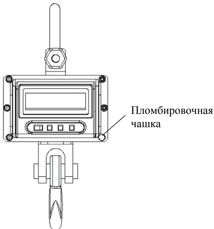
Рис. 16.1 - Место нанесения отпечатка поверительного клейма
