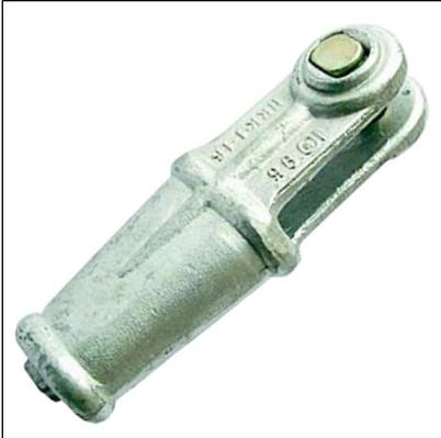
Зажим натяжной клиновой коушный **НKK-1-1Б** предназначен для крепления сталеалюминиевых проводов сечением от 10 до 50 мм<sup>2</sup> и стальных канатов сечением от 25 до 86 мм<sup>2</sup> к натяжным подвескам анкерно-угловых опор.
