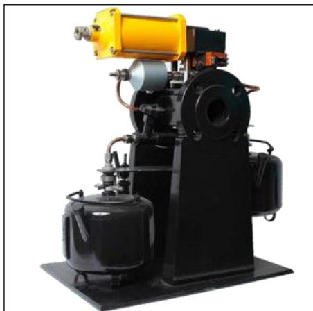
**Пробоотборник 1 Стандарт-А** - пробоотборник автоматический для отбора пробы нефти и нефтепродуктов, и др. жидкостей,; из трубопровода при рабочем давлении, от 0,2МПа до 6,3 МПа. Данный пробоотборник разработан в соответствии с ГОСТ 2517-85 (изменение № 1) «Нефть и нефтепродукты. Методы отбора проб».
