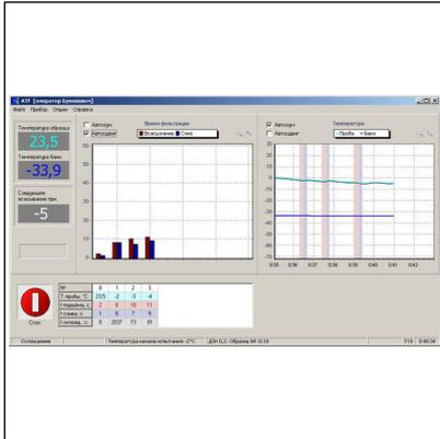
Программа **АТФ** предназначена для управления прибором АТФ-01, определяющим предельную температуру фильтруемости дизельных топлив согласно ГОСТ 22254, ASTM D6371, IP309, EN116.
