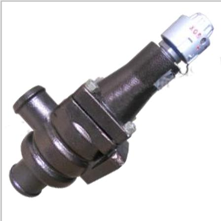
РТП-32Б регулятор температуры прямого действия недистанционный предназначен для автоматического регулирования температуры охлаждающей жидкости (раствор трехкомпонентной присадки в чистой мягкой воде в соотношении: хромпик калиевый или натриевый из расчета 1-1,2% по весу, нитрит натрия и тринатрий фосфата из расчета 0,05% по весу, низкозамерзающие жидкости "40 и 65" (ГОСТ 28084-89)) в системах охлаждения дизелей типа Дб и Д12.
