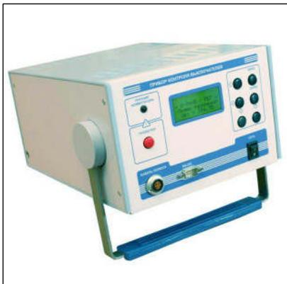
Прибор «ПУВ-регулятор» предназначен для управления приводами постоянного тока при проведении ремонтных работ и проверке технического состояния всех типов высоковольтных выключателей, проверки выключателей при пониженном напряжении.
