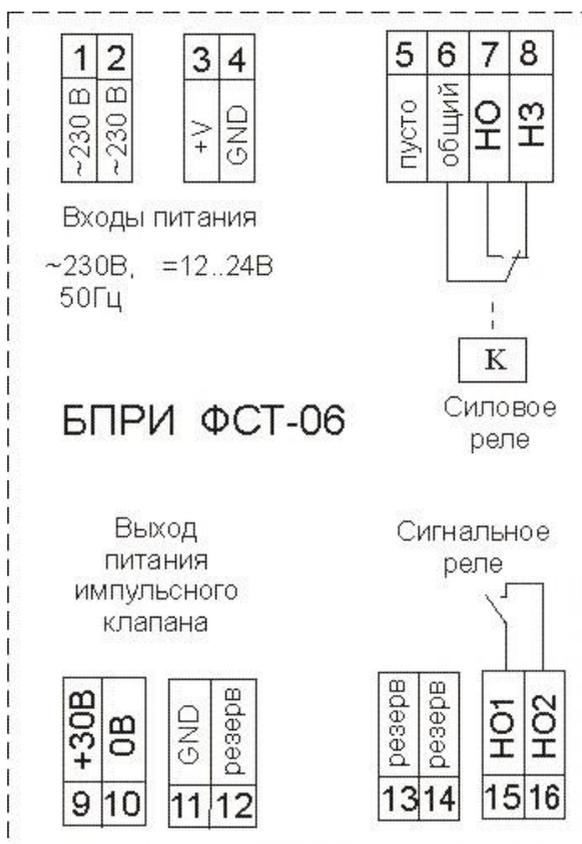
Рисунок. 5.2 Монтажные клеммы
