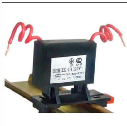
Ограничители перенапряжений «ОПН-1», «ОПН-2» предназначены для ограничения коммутационное перенапряжение на катушках аппарата до 2-х кратного амплитудного значения напряжения цепи управления для напряжений 110В, 220В, 380В и до 4-х кратного - для напряжений 24В, 48В. Элементная база R-С, и варистор. Ограничители устанавливаются на пускатели и контакторы со степенью защиты IP00, IP20.
