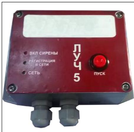
Контроллер предназначен для управления сиренами типа С - 40, С - 28 по каналам GSM связи или в ручном режиме. Контроллер выполнен в виде отдельного блока со степенью защиты от попадания пыли и влаги по ГОСТ 14254-96 (IP 54).
