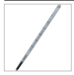
Ртутный стеклянный термометр с вложенной шкалой из молочного стекла, который предназначен для измерения температуры при отсчетах по чашечному ртутному барометру для приведения его показаний к температуре 0. Изготавливается по ГОСТ 112-78. Внесен в Государственный реестр средств измерений и имеет сертификат "об утверждении типа средств измерений".
